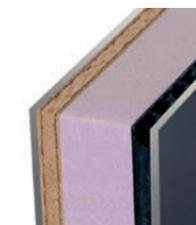
résistance à la compression de 300 kPa. Cette structure intérieure peut être complétée par des contreplaqués ou des composites alvéolaires\* accolés aux habillages ou, selon l'épaisseur, remplacés par une âme multiplies (voir descriptif dans les catalogues panneaux). Les panneaux peuvent également s'épaissir de 20 mm à 75 mm (et plus sur demande) au gré des besoins et des performances ciblées.
