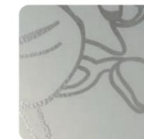
Procédé de dépolissage et de gravure du verre obtenu par projection puissante de sable suivant un modèle de pochoir. Convient à tous les styles, modernes et traditionnels.
