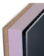
Cette structure intérieure peut être complétée par des contreplaqués ou des composites alvéolaires\* accolés aux habillages ou, selon l'épaisseur, remplacés par une âme multiplis. Les panneaux peuvent également s'épaissir de 20 mm à 75 mm (et plus sur demande). Ils sont dotés, de série, d'un double vitrage 33.2 feuilleté extérieur et d'un verre de 4 mm intérieur.
