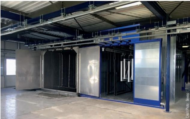
Machine à laquer Bewap de grande capacité installée chez AG dynamics. Elle permet de produire 4 palonniers de 6 m de long par 2,2 m de haut et 400 mm de large en même temps tous les ¼ heures dans la cabine de traitement de surface, entièrement en inox
